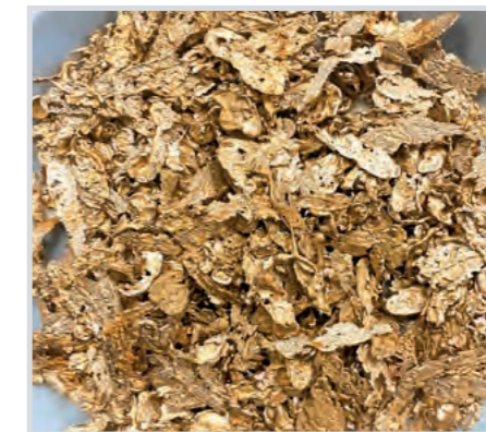
Mit dem optionalen Flake-Kit können statt Granalien auch dünne Flakes produziert werden.
