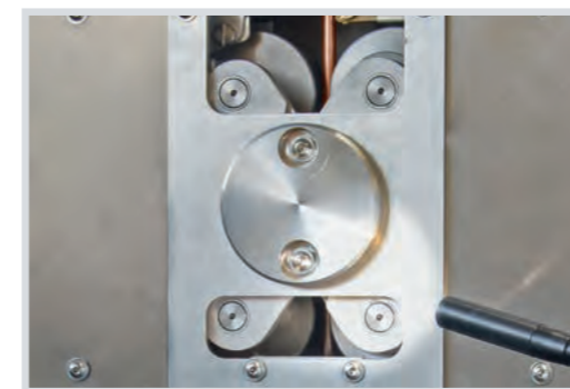
Das Quattro-Antriebssystem mit vier Transportrollen. Rechts im Bild der bewegliche LED-Strahler zur besseren Kontrolle des Gieß-Strangs.
