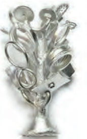
Ein wesentlicher Faktor für die Wirtschaftlichkeit ist die geringe Metallmenge, die für den Anguss einkalkuliert werden muss.
