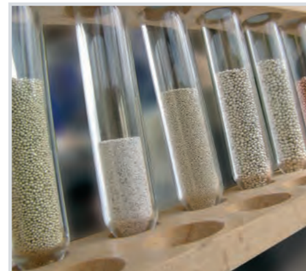
Microgranulat in verschiedenen Legierungen in Korngrößen zwischen 0,1 und 1 mm.
