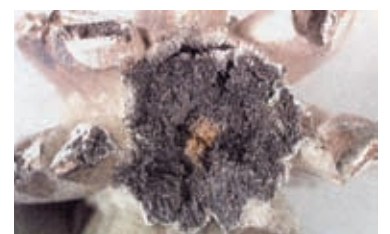
Из-за очень интенсивного образования дендритов возникает опасность высокотемпературной хрупкости (Hot Crack) и замедления тока материала.
