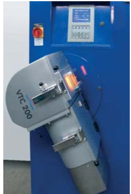
Das Gießen erfolgt durch eine 90°-Drehung der gesamten Gießeinheit
