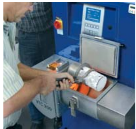
Geräumige Vakuumkammer für Küvetten bis 125 mm Ø / 220 mm H
