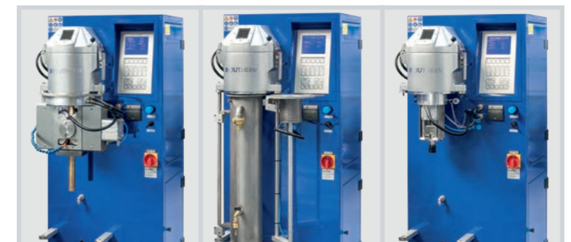
VCC 400 im Stranggießbetrieb Dieselbe Anlage als Granuliereinheit... ...und hier ausgestattet mit dem Sinter-Kit Die Programmsteuerung erkennt die eingesetzte Ausstattung und stellt auf dem Display die passenden Parameter ein.
