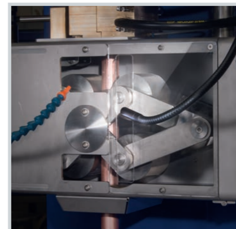
Das Quattro-Antriebssystem mit vier Transportrollen. Links im Vordergrund das zusätzliche Sekundärkühlsystem, rechts der bewegliche LED-Strahler zur einfacheren Zuführungssteuerung.
