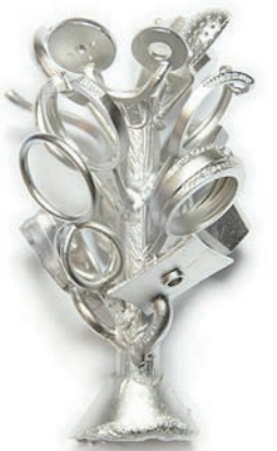
Ein wesentlicher Faktor für die Wirtschaftlichkeit ist die geringe Metallmenge, die für den Anguss einkalkuliert werden muss.
